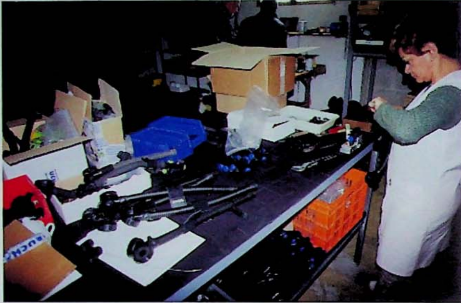
Abb. 13: Montage des Inflatorschlauchs und des Ablaßventils.
