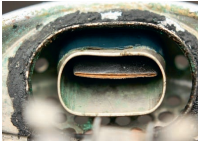
Bild34: Entenschnabel vom Inneren des Healthways-Reglers her, ohne die schwarze Schutzkappe
