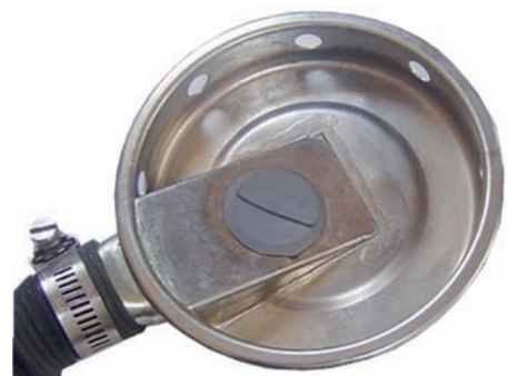
Bild56: Ausatemventil des Healthways Scuba (USA)
