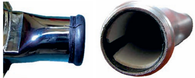
Bild 26: Abgebundener Entenschnabel-Hals auf dem Ausatemstutzen
