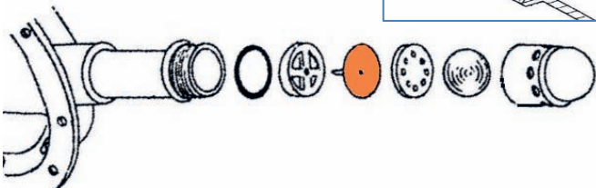
Bild70: Schema Hornventile am Siebe/Gorman-Regler
