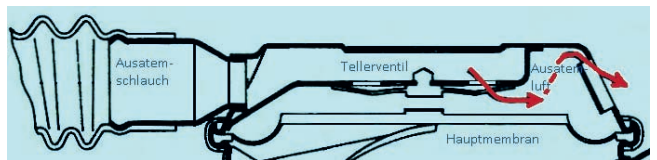
Bild54: Schema des Ausatemventils des Nemrod Snark III (Spanien)
