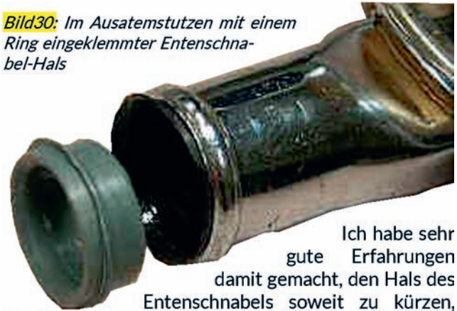
Bild 28: Im Ausatemstutzen mit einer Ringfeder eingeklemmter Entenschnabel-Hals
