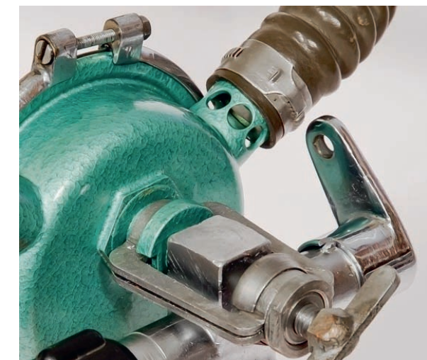
Bild44: Scheibenventil und Ausatemlöcher im Ausatemstutzen (eines tschechischen AV1)
