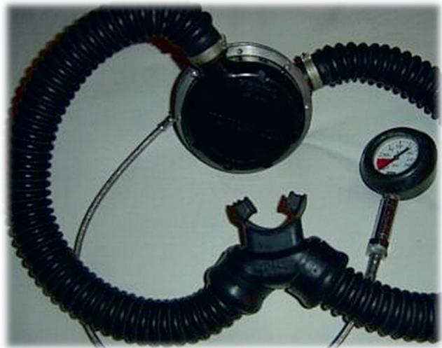
Einatem- und Ausatemschläuche liegen jeweils über der Schulter, wobei der von der Oberfläche kommende Luftzufuhrschlauch am unteren Rand des Gehäuses angeschlossen ist, so dass die drei Schläuche den Buchstaben Y bilden.
