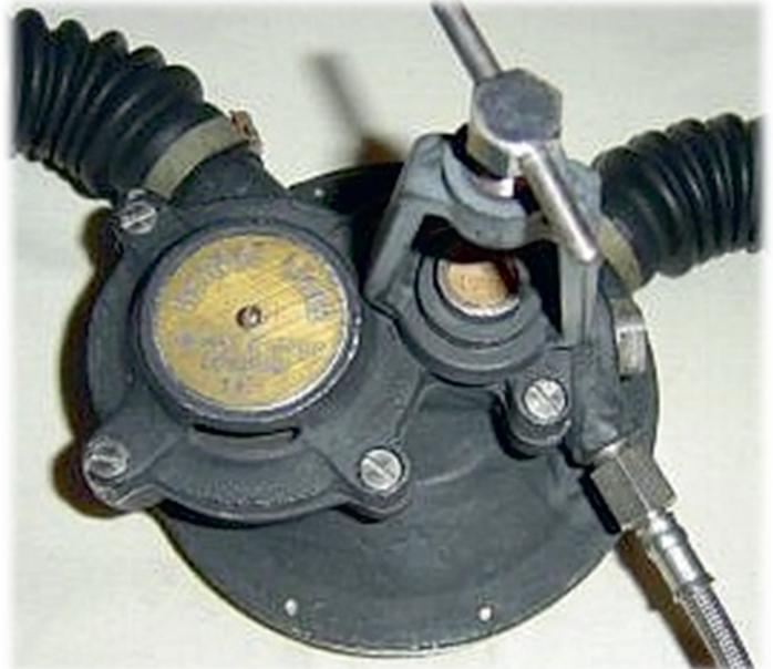
Die Abdeckung war mit dem Namen des Herstellers und der Bezeichnung "Venturi Jet" geprägt, die Mk-Nummer fehlte. Zunächst baute Heinke ein "Entenschnabel"-Auslassventil in die neue Abdeckung
