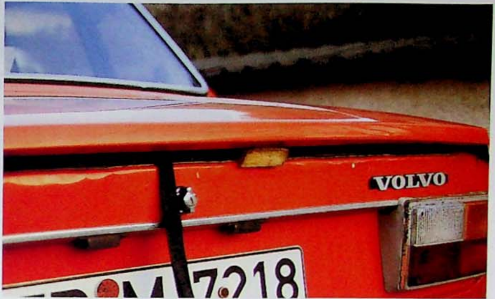
Als ausreichende Belüftung des Kofferraums wird ein Spalt, gesichert durch Keil und Gummizug, erachtet ...
