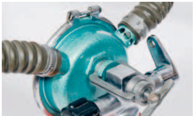
Rückansicht AV1, INT-Bügel, Ausatemventil am Schlauch (D. Šuráni)
