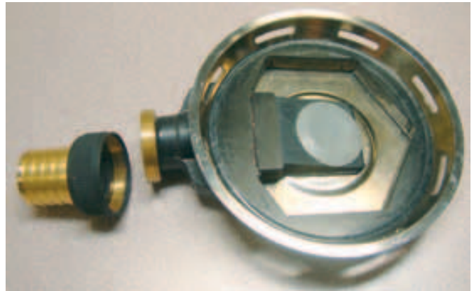
Modifizierte Regler-Oberschale des Saturn (L. Seveke)
