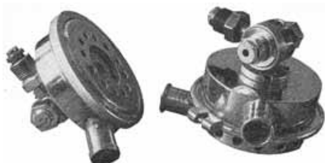
Weiterer Eigenbauregler mit erster Stufe des KP-14 (K. Spacek)
